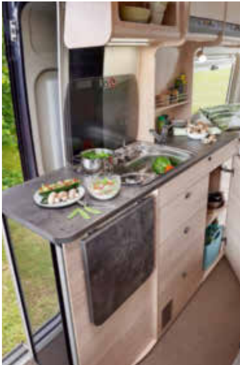
Comfortabele keuken Tweepits kooktoestel met piëzo-ontsteking
